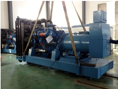
东南亚客户 2台600KW MTU发电机组
